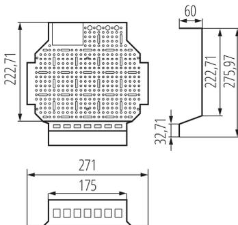
KDB-S/F Multimediakarten sind eine praktische Lösung, die elektrischen Schalttafeln in teletechnische (Multimedia-) Schalttafeln umzuwandeln. Die Medientafel wird einfach an der Stelle der DIN-Schiene montiert. Dabei werden lediglich die DIN-Schienen zerlegt und an ihrer Stelle die Multimedia-Karten eingesetzt. Das gilt für zweireihige KDB-Schaltanlagen für 12 und 18 Module (Unterputz/Aufputz-Montage).
