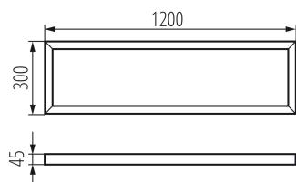
Kanlux-ADTR-Rahmen sind für Kanlux-BRAVO- und Kanlux-BLINGO-Paneele konzipiert und ermöglichen die Aufputzmontage. Kanlux ADTR-Rahmen sind in verschiedenen Farben und Größen erhältlich und passen zu allen Kanlux LED-Paneele und den meisten LED-Paneele auf dem Markt.
