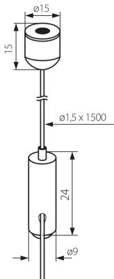
ROPE-NT 150 SINGLE Stahlseil (einfach) zum Aufhängen von Leuchten, 2 Stück im Lieferumfang enthalten
