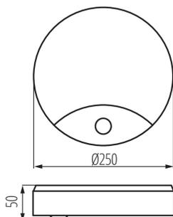
Le plafonnier Kanlux SANSO LED avec capteur de mouvement PIR intégré vous permet de le personnaliser selon vos besoins. Il se caractérise également par une étanchéité accrue (IP 44), grâce à laquelle son intérieur est protégé contre les poussières.
