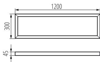
Les cadres Kanlux ADTR sont conçus pour les panneaux Kanlux BRAVO et Kanlux BLINGO et permettent un montage en saillie. Les cadres Kanlux ADTR sont disponibles en différentes couleurs et tailles pour s'adapter à tous les panneaux LED Kanlux et à la plupart des panneaux LED disponibles sur le marché.
