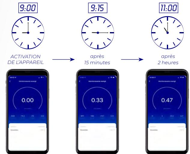
Le test a été effectué lors du raccordement d'un radiateur soufflant d'une puissance max. 2000W pendant 2h.
