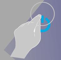
Connectez l'adaptateur de prise à une prise à contact de protection. Maintenez enfoncé le bouton ON / OFF pendant environ 5 secondes jusqu'à ce que la LED bleue clignote rapidement.
