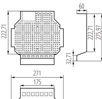
KDB-S/F Multimediacarten sind eine praktische Lösung, die elektrischen Schalttafeln in teletechnische (Multimedia-) Schalttafeln umzuwandeln. Die Medientafel wird einfach an der Stelle der DIN-Schiene montiert. Dabei werden lediglich die DIN-Schienen zerlegt und an ihrer Stelle die Multimedia-Karten eingesetzt. Das gilt für zweireihige KDB-Schaltanlagen für 12 und 18 Module (Unterputz/Aufputz-Montage).
