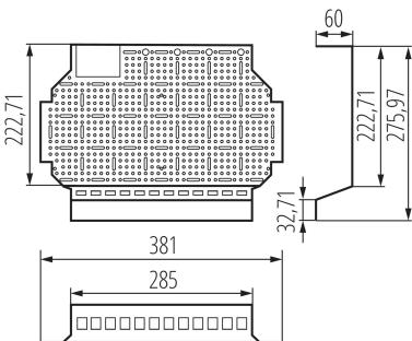
KDB-S/F Multimediacarten sind eine praktische Lösung, die elektrischen Schalttafeln in teletechnische (Multimedia-) Schalttafeln umzuwandeln. Die Medientafel wird einfach an der Stelle der DIN-Schiene montiert. Dabei werden lediglich die DIN-Schienen zerlegt und an ihrer Stelle die Multimedia-Karten eingesetzt. Das gilt für zweireihige KDB-Schaltanlagen für 12 und 18 Module (Unterputz/Aufputz-Montage).
