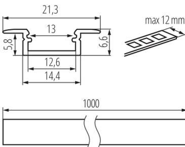
Einbau-Deko-Profil für LED-Lichtstreifen.
