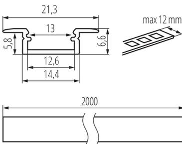
Einbau-Deko-Profil für LED-Lichtstreifen.
