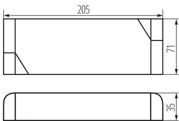
Kanlux POWELED ist ein elektronisches Gleichstromnetzteil. Je nach Ausführung des LED-Streifen, wird ein Netzteil mit 12V oder 24V Betriebsspannung verwendet.
