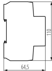
KDEM-3P LCD est un dispositif de monitorage de la consommation électrique d'un réseau triphasé, dans des applications commerciales et industrielles, il mesure et affiche la consommation de puissance active (kWh). Le compteur utilise une méthode de mesure directe 5A(100A). KDEM-3P LCD est un compteur répondant aux exigences de la directive MID (classe de précision B).
