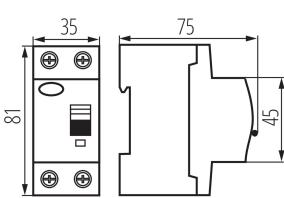
Le disjoncteur différentiel : utilisé comme protection supplémentaire contre les chocs électriques, il est conçu pour fonctionner dans des circuits de courant alternatif sinusoïdal (type AC) et de courant alternatif et pulsatoire sinusoïdal avec une composante constante (type A).
