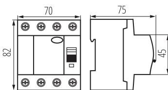
Le disjoncteur différentiel : utilisé comme protection supplémentaire contre les chocs électriques, il est conçu pour fonctionner dans des circuits de courant alternatif sinusoïdal (type AC) et de courant alternatif et pulsatoire sinusoïdal avec une composante constante (type A).
