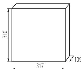
Les appareils de commutation de la série KDB répondant aux exigences de résistance aux braises à 650°C, peuvent être utilisés seulement sur des surfaces incombustibles (par ex. parois solides et pleines, en matériaux incombustibles). Ils ne peuvent pas être utilisés sur des surfaces inflammables (par ex. plaques de plâtre, bois, etc.), sur des parois dites « creuses » ou sur des gaines électriques.
