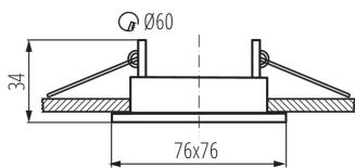
Kanlux ALOR est une gamme riche en couleurs de points LED les plus demandés, d'un diamètre de 8,3 cm. Les points LED ne sont pas dotés de support en céramique. Il est possible de les utiliser avec des boîtiers compatibles avec les culots GU10 ou Gx5,3, ce qui permettra d'installer des sources lumineuses adaptées au projet.
