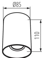
Kanlux RITI est conçu en aluminium, la structure de la surface sablée est peinte en mat et le réflecteur est recouvert d'une couche de laque or-cuivre avec un pigment brillant. La série Kanlux RITI se caractérise par une bonne qualité de fabrication et un design moderne. On peut l'utiliser comme système d'éclairage autonome ou en combinaison avec plusieurs luminaires.
