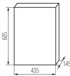
Les appareils de commutation de la série KDB répondant aux exigences de résistance aux braises à 650°C, peuvent être utilisés seulement sur des surfaces incombustibles (par ex. parois solides et pleines, en matériaux incombustibles). Ils ne peuvent pas être utilisés sur des surfaces inflammables (par ex. plaques de plâtre, bois, etc.), sur des parois dites « creuses » ou sur des gaines électriques.
