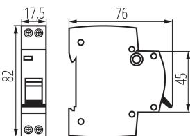
Le disjoncteur avec protection contre les surintensités est utilisé pour la protection des câbles contre les surcharges et les courts-circuits dans les installations et les appareils.
