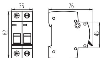
Le disjoncteur avec protection contre les surintensités est utilisé pour la protection des câbles contre les surcharges et les courts-circuits dans les installations et les appareils.
