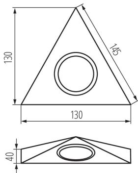
La gamme Kanlux ZEPO sont des spots encastrables pour les étagères, par exemple pour éclairer le plan de travail dans la cuisine. ZEPO sont disponibles dans la version avec et sans interrupteur. La source lumineuse est destinée pour les points lumineux JC avec culot G4.
