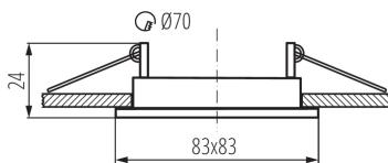
Точечные светильники Kanlux ALOR – это неограниченная свобода выбора поворотных и неповоротных арматур. Богатая цветовая палитра одного из самых популярных потолочных светильников диаметром 8,3 см. В комплекте светильников отсутствует керамический цоколь это позволяет Вам самостоятельно подобрать или GU10 или Gx5,3. Такие патроны позволяют подобрать источники света, подходящие именно Вам по мощности, цветовой температуре и световому потоку
