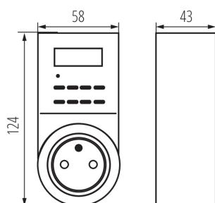
Kanlux CYBER ist eine digitale Zeitschaltuhr ausgestattet mit einer Steckdose und einem 24-Stunden-Digitalprogrammierer. Dadurch lässt sich ein elektrischer Verbraucher automatisch ein- oder ausschalten.
