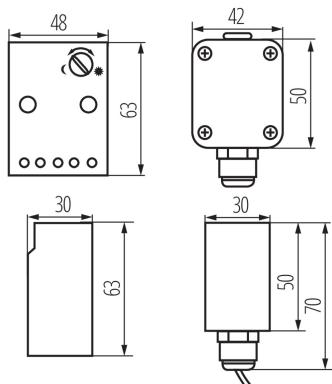
Kanlux AZ-10A ist ein Dämmerungsschalter. Er dient zum Ein- und Ausschalten von Beleuchtungskreisen oder anderen elektrischen Geräten in Abhängigkeit von der natürlichen Lichtintensität (Tag/Nacht).
