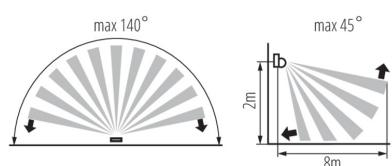
Der ALER MINI-W ist ein kleiner Infrarotsensor mit einem beeindruckenden und minimalistischen Design. Der Sensor hat einen horizontalen Winkel von 140°, einen vertikalen Winkel von 45° und kann dank seiner einfachen mechanischen Verstellung (vertikal 45°, horizontal 90°) an Ihre Bedürfnisse angepasst werden. Er hat eine hohe Schutzart (IP44), was bedeutet, dass der Sensor an Orten installiert werden kann, die direkt der Witterung ausgesetzt sind.
