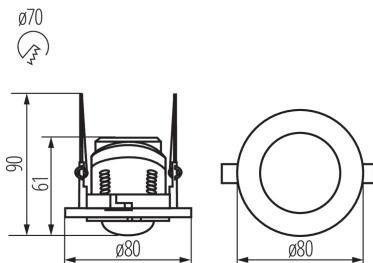
Kanlux MERGE ADJ ist ein PIR-Bewegungsmelder mit einer maximalen Reichweite von 5m. Sein maximaler horizontaler Wirkungswinkel beträgt 360 Grad. Der MERGE ADJ-Sensor ermöglicht es Ihnen, Parametereinstellungen vorzunehmen, ohne den Sensor demontieren zu müssen.
