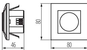
Kanlux MERGE MW ist eine ästhetische und funktionelle Lösung. Die maximale Reichweite beträgt 9 Meter. Die Beleuchtungszeit und Umgebungshelligkeit, bei der der Sensor arbeitet, ist einstellbar.
