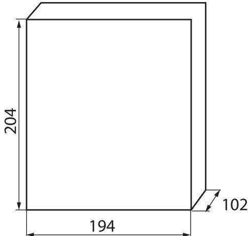
Die Verteilerkästen der Serie KDB, die die Anforderung der Gluthärtigkeit bei einer Temperatur von 650°C erfüllen, dürfen nur auf nicht brennbaren Oberflächen (z. B. feste, feste Wände, aus nicht brennbaren Materialien) eingesetzt werden. Sie dürfen nicht auf brennbaren Oberflächen (z. B. Gipskartonplatten, Holz usw.), auf sogenannten „leeren Wänden“ oder in technischen Bereichen eingesetzt werden.
