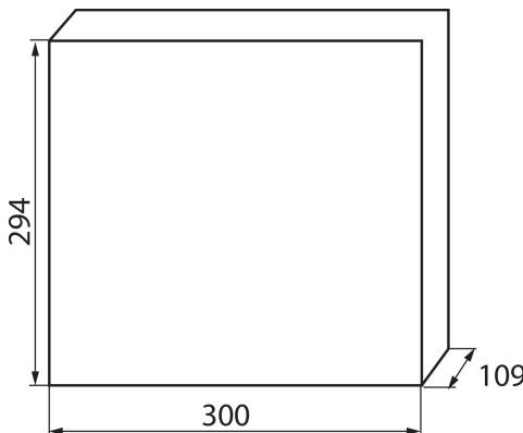
Die Verteilerkästen der Serie KDB, die die Anforderung der Gluthärtigkeit bei einer Temperatur von 650°C erfüllen, dürfen nur auf nicht brennbaren Oberflächen (z. B. feste, feste Wände, aus nicht brennbaren Materialien) eingesetzt werden. Sie dürfen nicht auf brennbaren Oberflächen (z. B. Gipskartonplatten, Holz usw.), auf sogenannten „leeren Wänden“ oder in technischen Bereichen eingesetzt werden.
