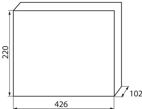
Die Verteilerkästen der Serie KDB, die die Anforderung der Gluthärtigkeit bei einer Temperatur von 650°C erfüllen, dürfen nur auf nicht brennbaren Oberflächen (z. B. feste, feste Wände, aus nicht brennbaren Materialien) eingesetzt werden. Sie dürfen nicht auf brennbaren Oberflächen (z. B. Gipskartonplatten, Holz usw.), auf sogenannten „leeren Wänden“ oder in technischen Bereichen eingesetzt werden.
