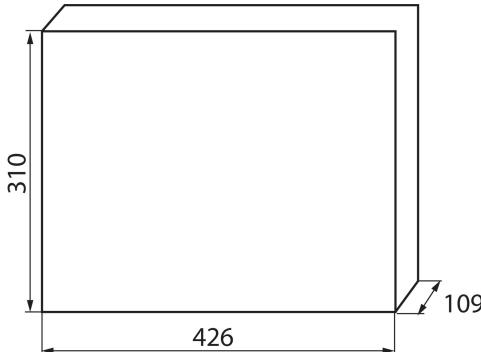
Die Verteilerkästen der Serie KDB, die die Anforderung der Gluthärtigkeit bei einer Temperatur von 650°C erfüllen, dürfen nur auf nicht brennbaren Oberflächen (z. B. feste, feste Wände, aus nicht brennbaren Materialien) eingesetzt werden. Sie dürfen nicht auf brennbaren Oberflächen (z. B. Gipskartonplatten, Holz usw.), auf sogenannten „leeren Wänden“ oder in technischen Bereichen eingesetzt werden.
