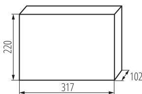
Die Verteilerkästen der Serie KDB, die die Anforderung der Glutbeständigkeit bei einer Temperatur von 650°C erfüllen, dürfen nur auf nicht brennbaren Oberflächen (z. B. feste, feste Wände, aus nicht brennbaren Materialien) eingesetzt werden. Sie dürfen nicht auf brennbaren Oberflächen (z. B. Gipskartonplatten, Holz usw.), auf sogenannten „leeren Wänden“ oder in technischen Bereichen eingesetzt werden.
