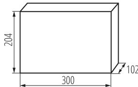
Die Verteilerkästen der Serie KDB, die die Anforderung der Glutbeständigkeit bei einer Temperatur von 650°C erfüllen, dürfen nur auf nicht brennbaren Oberflächen (z. B. feste, feste Wände, aus nicht brennbaren Materialien) eingesetzt werden. Sie dürfen nicht auf brennbaren Oberflächen (z. B. Gipskartonplatten, Holz usw.), auf sogenannten „leeren Wänden“ oder in technischen Bereichen eingesetzt werden.
