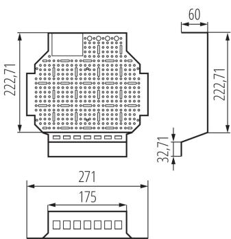
KDB-S/F Multimediacarten sind eine praktische Lösung, die elektrischen Schalttafeln in teletechnische (Multimedia-) Schalttafeln umzuwandeln. Die Medientafel wird einfach an der Stelle der DIN-Schiene montiert. Dabei werden lediglich die DIN-Schienen zerlegt und an ihrer Stelle die Multimedia-Karten eingesetzt. Das gilt für zweireihige KDB-Schaltanlagen für 12 und 18 Module (Unterputz/Aufputz-Montage).
