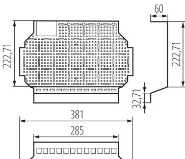
KDB-S/F Multimediacarten sind eine praktische Lösung, die elektrischen Schalttafeln in teletechnische (Multimedia-) Schalttafeln umzuwandeln. Die Medientafel wird einfach an der Stelle der DIN-Schiene montiert. Dabei werden lediglich die DIN-Schienen zerlegt und an ihrer Stelle die Multimedia-Karten eingesetzt. Das gilt für zweireihige KDB-Schaltanlagen für 12 und 18 Module (Unterputz/Aufputz-Montage).
