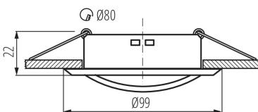
Kanlux ALOR ist eine Familie von Leuchten in den beliebtesten Farben: schwarz und weiß, mit einer matten Oberfläche. Die Leuchten werden nicht mit einer Keramikfassung geliefert. Es ist möglich, eine Fassung zu verwenden, die in einen GU10- oder Gx5.3-Schraubsockel passt, was die Verwendung von Lichtquellen ermöglicht, die an die vorbereitete Installation angepasst sind.
