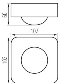
Kanlux SENTO ist ein elektronischer Sensor zur Bewegungserkennung. Seine Einzigartigkeit liegt darin, dass bis zu drei Infrarotdetektoren in einem Sensor installiert sind. Dies gewährleistet eine beispiellose Empfindlichkeit und ermöglicht sogar das Erkennen kleinstter Bewegungen. Kanlux SENTO wird aufgrund seiner ungewöhnlichen Eigenschaften als Präsenzmelder bezeichnet.
