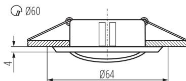
Kanlux CEL ist eine Deckenspotleuchte aus Aluminium in matter Chromfarbe. Sie haben die Möglichkeit eine Glühlampe mit einem Gx4-Sockel zu verwenden.
