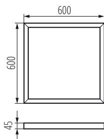
Montagerahmen Kanlux ADTR zur Aufputzmontage sind in verschiedenen Farben und Größen, passend zu allen Kanlux BRAVO Panels, erhältlich.
