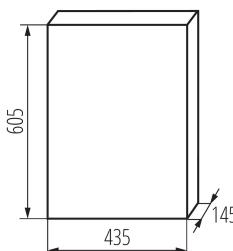
Die Verteilerkästen der Serie KDB, die die Anforderung der Glutbeständigkeit bei einer Temperatur von 650°C erfüllen, dürfen nur auf nicht brennbaren Oberflächen (z. B. feste, feste Wände, aus nicht brennbaren Materialien) eingesetzt werden. Sie dürfen nicht auf brennbaren Oberflächen (z. B. Gipskartonplatten, Holz usw.), auf sogenannten „leeren Wänden“ oder in technischen Bereichen eingesetzt werden.
