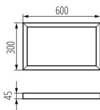
Montagerahmen Kanlux ADTR zur Aufputzmontage sind in verschiedenen Farben und Größen, passend zu allen Kanlux BRAVO Panels, erhältlich.
