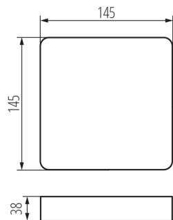
Kanlux TAVO FRAME Rahme ermöglicht die Aufbaumontage von Kanlux TAVO LED-Paneele in den Versionen 12W und 18W. Die Dichtigkeit der Paneele nach der Montage beträgt IP20.
