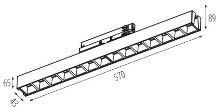
**PARAMETER FÜR LED- UND OLED-LICHTQUELLEN:****Ähnliche Farbtemperatur [K]:** 3000**Farbkonsistenz in MacAdam-Ellipsen:** ≤6**Farbwiedergabeindex:** 80**LOGISTIKDATEN:****Maßeinheit:** Stück**Verpackungsart:** 1**Stückzahl in Zwischenverpackung:** 1**Stückzahl in Großverpackung:** 1**Netto-Einzelgewicht [g]:** 820**Grammatür [g]:** 1040**Kartongewicht [kg]:** 1.04
