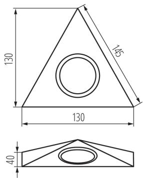
Kanlux ZEPO-Spotleuchten ist eine Beleuchtung, die unter anderem für Schränke über der Küchenarbeitsplatte gedacht ist. ZEPO sind in einer Version mit und ohne Schalter erhältlich. Für die Leuchten ist ein Netzteil erforderlich, z.B. aus der SET-Serie. In den Spotleuchten wird das Leuchtmittel mit einem G4-Sockel verwendet.
