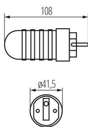
Eine Steckdose für Verlängerungskabel. STAN GP verfügt über die Schutzklasse I gegen elektrischen Schlag. GRIP GP/S ist ausgestattet mit Erdung vom Typ Schuko.
