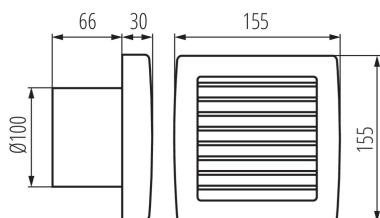
Die Ventilatoren der Kanlux TWISTER AOL-Serie sind in zwei Größen mit einem Durchmesser von 100 und 120 mm erhältlich. Sie sind aus Kunststoff, in der Farbe: weiß. Ihre Leistung beträgt 19 bzw. 20 W. Die Anzahl der Umdrehungen von jeder Größe beträgt 2550/min.
