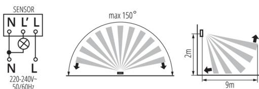
Kanlux MERGE JQ ist ein Bewegungsmelder mit einer maximalen Reichweite von 9 Metern. Der horizontale Winkel des Sensors beträgt 360 Grad. Die Beleuchtungszeit und Umgebungshelligkeit, bei der der Sensor arbeitet, ist einstellbar.
