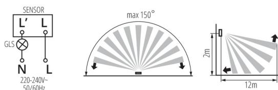
Kanlux MARID JQ ist ein Bewegungsmelder mit einer maximalen Reichweite von 12 Metern. Die Beleuchtungszeit und Umgebungshelligkeit, bei der der Sensor arbeitet, ist einstellbar. Der Sensor kann auch durch ein akustisches Signal ausgelöst werden.
