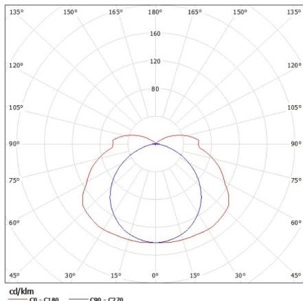
**KANLUX S.A. (kat 18521) MAH PLUS-236 - T8 LED SMD / Krzywa rozsyłu światła (biegunowo)**Oprawa: KANLUX S.A. (kat 18521) MAH PLUS-236 - T8 LED SMD
