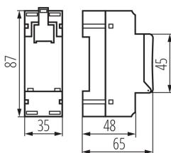
Le programmeur temporel sert à allumer et éteindre les circuits d'alimentation du dispositif l'éclairage grâce à la programmation journalière. Le programmeur temporel est doté de 8 points temporels programmables pour allumages (ON) et extinctions (OFF). Le programmeur est doté de la fonction de décalage temporel ON/OFF conforme aux changements astronomiques journaliers des heures de lever et de coucher du soleil.
